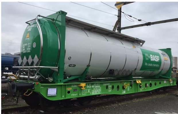
Bild 3: B-TC auf eigens dafür ausgelegten Tragwagen (SBB Infrastruktur, 08.11.2017)
