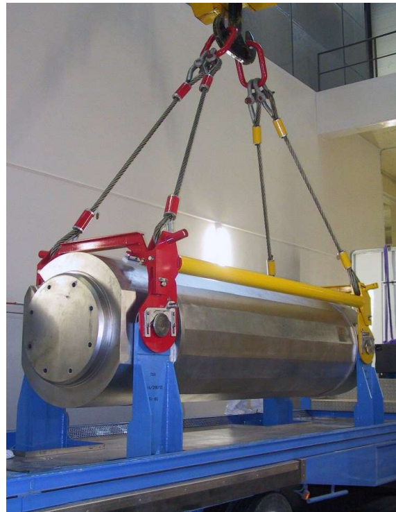
Transportbehälter (Typ B(U)-Versandstück)
