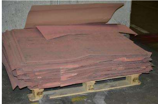
Rutschhemmendes Material (RHM) als Auflage und Trennung
