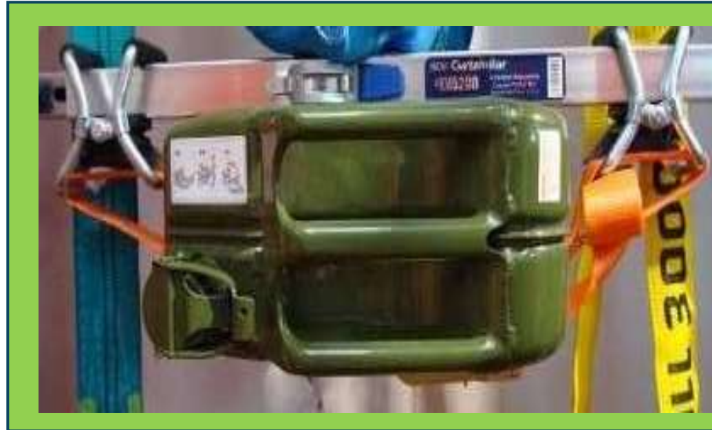
Bordwandanker (Umreifung möglich bis 200 daN)
