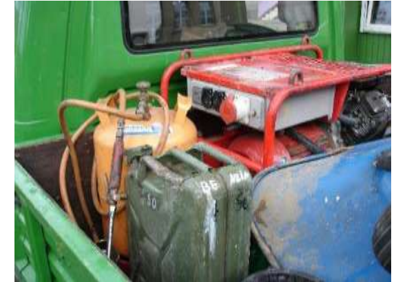
Mangelhafte Ladungssicherung und fehlender Ventilschutz
